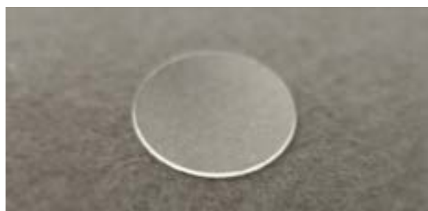
图 2: 从 150 μm 厚蓝宝石晶片上切割的 5 mm 圆片的微距照相机照片
