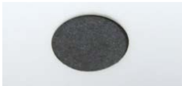
图 3: 在 200 μm 厚氧化铝陶瓷板中加工的 5 mm 直径孔的数码相机照片显示出极高的边缘质量，且材料无变色。
