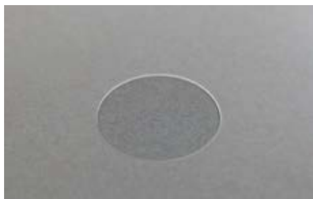
图 1：在 200 μm 厚 Corning Willow 玻璃中切割出的 10 mm 直径孔
